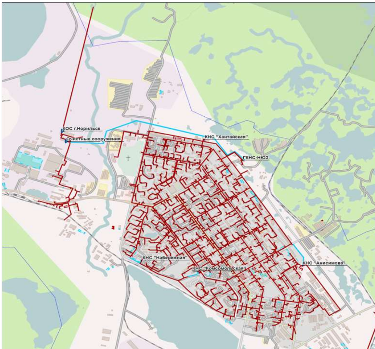
Рисунок 35 - Картосхема зоны действия централизованной системы водоотведения Центрального района на территории муниципального образования город Норильск
