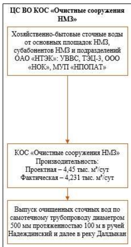
Рисунок 32 - Структурная схема централизованного водоотведения на территории КОС НМЗ муниципального образования город Норильск
