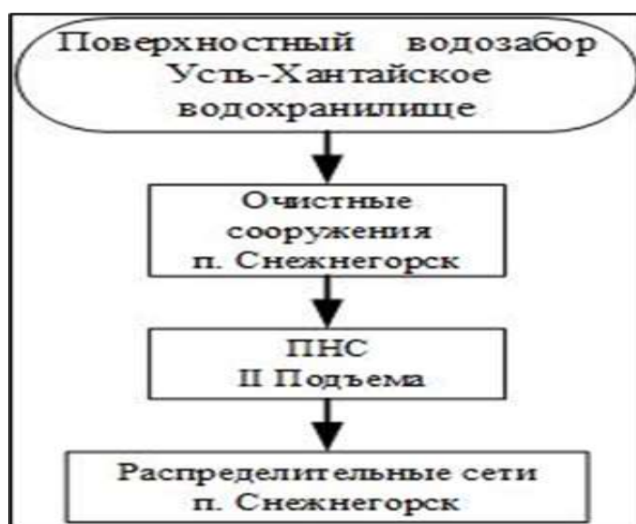
Рисунок 23 - Структурная схема централизованного питьевого водоснабжения г.п. Снежногорск
